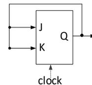
8) Il flip-flop JK montato come in figura ha un'uscita Q che:
