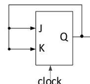
8) Il flip-flop JK montato come in figura ha un'uscita Q che:
